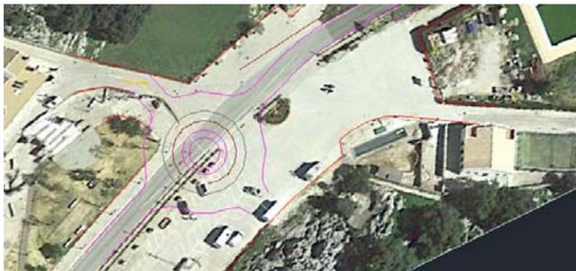
En esta propuesta se cumple con todos los parámetros de construcción según la normativa de trazado y se propone un ancho de rotonda de 35 m y carriles 12.6 m
